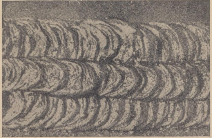
Bild 3 a. An der Schweißraupe sind keine Rißbildungen zu erkennen.
