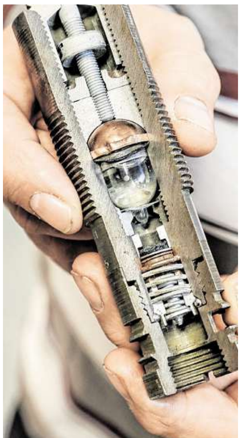
Ein chemischer Langzeitzünder mit Glasampulle. Wird sie zerstört, löst das darin befindliche Aceton eine darunterliegende Zelloidplatte auf. Ein Schlagbolzen wird freigelegt und löst die Detonation aus.
